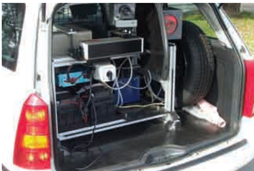
Slika 1: Merilniki hitrosti Multanova 6F so nameščeni v avtomobilih Renault Kangoo in Ford Focus
