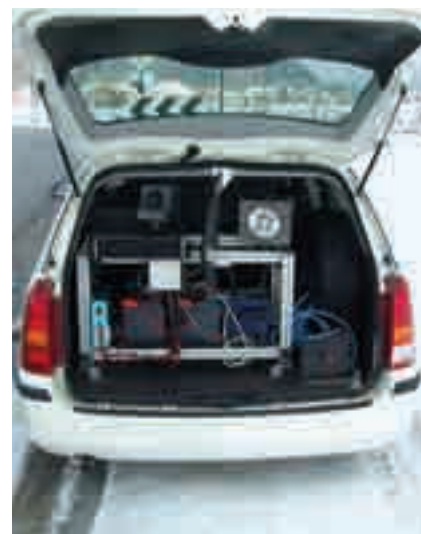
Slika 3: Merilniki hitrosti Gatsso 24 so nameščeni v avtomobilih Renault Kangoo in Ford Focus, lahko pa so postavljeni tudi samostojno na mestu meritve
